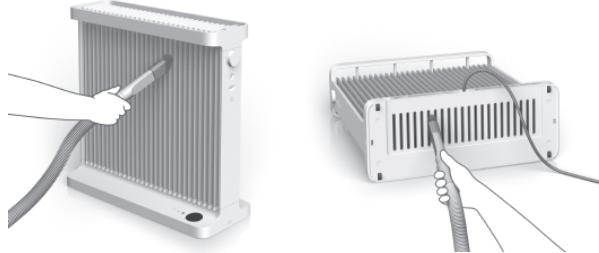
ラジエーターの隙間と、底面の吸気孔に溜まっているゴミや
