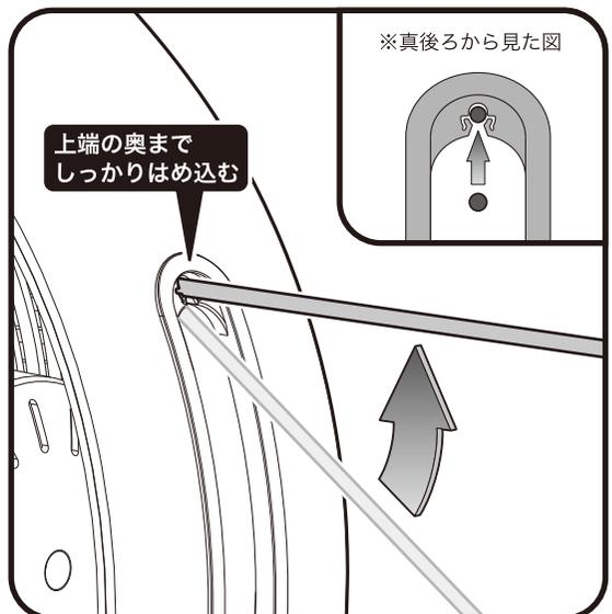
▲角度調整レール最上部の溝にはめ込み、固定してください。
