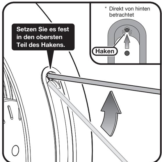
▲ Setzen Sie es in den Kanal auf der Oberseite der Winkleinstellungschiene und fixieren Sie es sicher.
