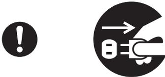
Bevor mit Wartungsarbeiten begonnen wird, muss das Produkt vom Netz getrennt werden.
