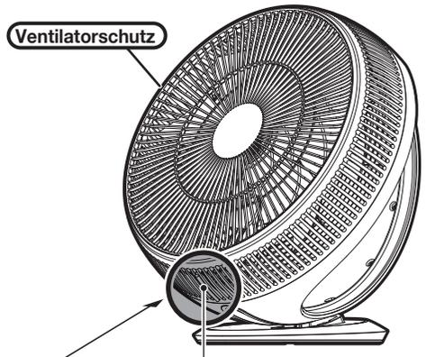
\* Der transparente Abschnitt an der Unterseite vorne am Ventilatorschutz ist der Empfänger für die Signale von der Fernbedienung.
