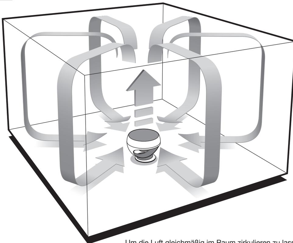
Um die Luft gleichmäßig im Raum zirkulieren zu lassen, wird empfohlen, **das Gerät in der Mitte des Zimmers aufzustellen und den Ventilator nach oben zu richten**. Die vom Zirkulierer abgegebene Luft tritt auf die Zimmerdecke und bewegt sich an den Wänden entlang; dies sorgt für eine effiziente Luftzirkulation.
