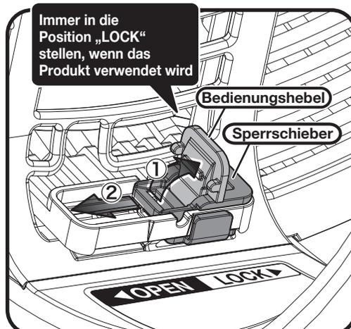
▲Schieben Sie den Sperrschieber aus der Position „LOCK“ in die Position „OPEN“.
