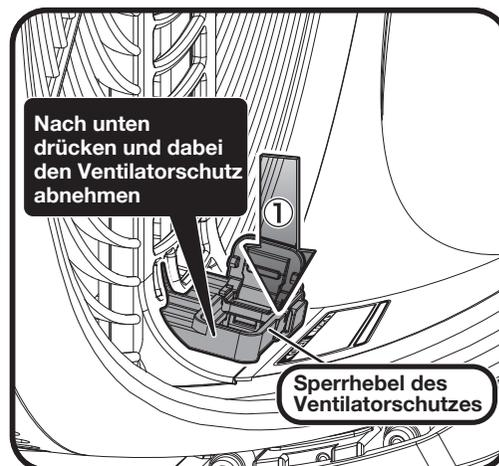
▲Entfernen Sie den Ventilatorschutz, indem Sie ihn von unten aus der Einrastung lösen, während Sie den Sperrhebel des Ventilatorschutzes nach unten gedrückt halten.
