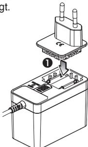
**2** Schieben Sie die Steckereinheit in Richtung **2**, bis sie mit einem Klicken einrastet.
