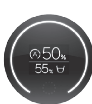
風量「0(送風停止)」の状態 風量「0」は白LEDが全灯します。
