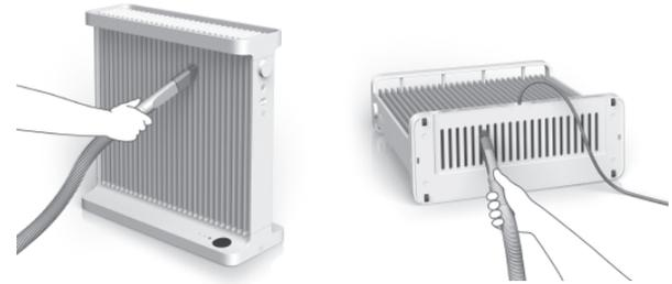
ラジエーターの隙間と、底面の吸気孔に溜まっているゴミやホコリは発熱の原因になりますので、掃除機などで必ず取り除いてください。
